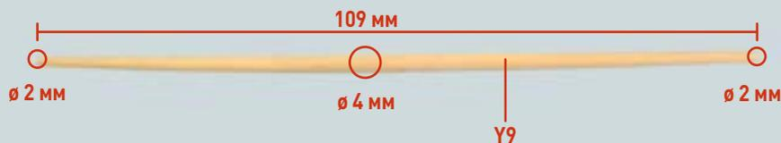
3 От стержня диаметром 4 x 300 мм, полученного с данным выпуском, отрежьте фрагмент длиной 109 мм. Сузьте его к концам так, чтобы их диаметр составлял 2 мм. Пометьте этот рей как Y9.
