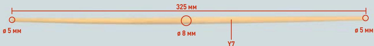
**1** Начнем нашу работу с изготовления нескольких новых реев. Возьмите стержень диаметром 8 x 350 мм, полученный с данным выпуском. Отрежьте от него фрагмент длиной 325 мм и сузьте его к концам так, чтобы их диаметр составлял 5 мм. Пометьте этот рей как Y7.
