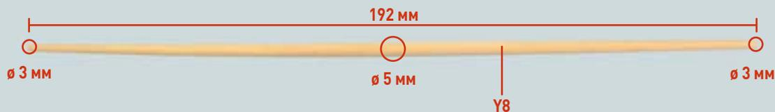
**2** От стержня диаметром 5 x 300 мм, который прилагается к данному выпуску, отрежьте фрагмент длиной 192 мм. Сузьте его к концам так, чтобы их диаметр составлял 3 мм. Пометьте этот рей как Y8.
