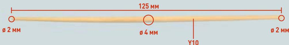
4 Из остатков стержня, с которым вы работали в предыдущем шаге, отрежьте фрагмент длиной 125 мм. Заузьте его концы таким образом, чтобы их диаметр составлял 2 мм. Пометьте этот рей как Y10.
